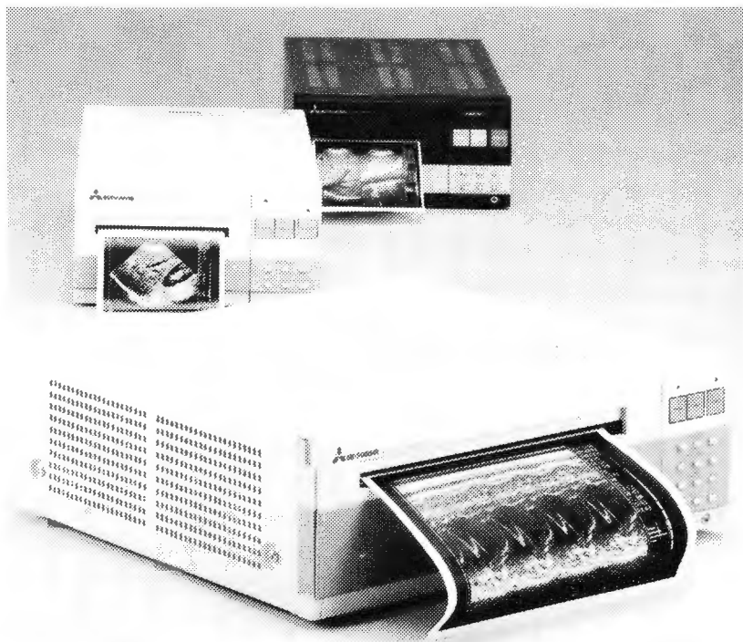
Videoprintere fra Matsushita koncernen giver hardcopy på termopapir. Udprinting sker på ca. 10 sekunder. Teknikken mestrer ikke farve endnu.
