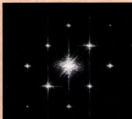
Fig 6: Det Fourier transformerede billede af fig 4. Midten svarer til lave frekvenser og yderkanterne til høje frekvenser. Stjernerne kommer på grund af rasterpunkterne i trykningen.
