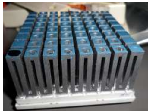
Optimeret køling på IBM 4381
