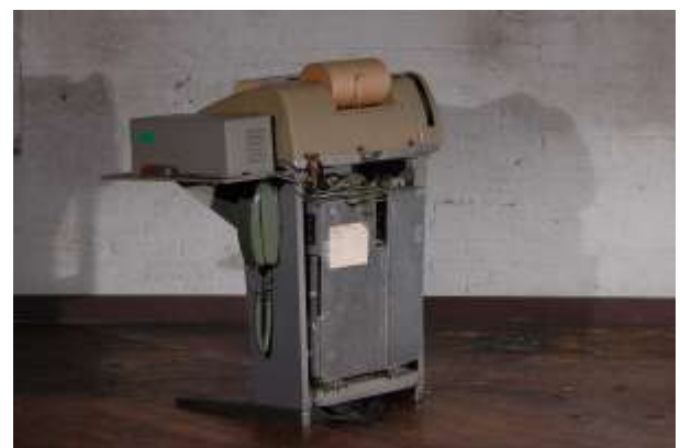
Bell 101C modem. Modemet er metalkassen under Teletypen
