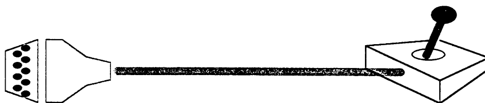
Fig. 1 : M3S forbindelse fra en enhed til bussen.
